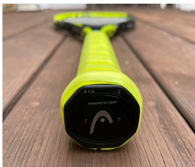
Figure 1. Capteur d'analyse de mouvement monté sur une raquette de tennis (HEAD Tennis Sensor ; ZEPP).
