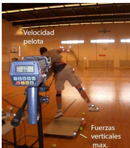
Figura 1. Las fuerzas verticales máximas y la velocidad de la pelota tras el impacto se determinaron mediante una plataforma de fuerza y un radar respectivamente.
